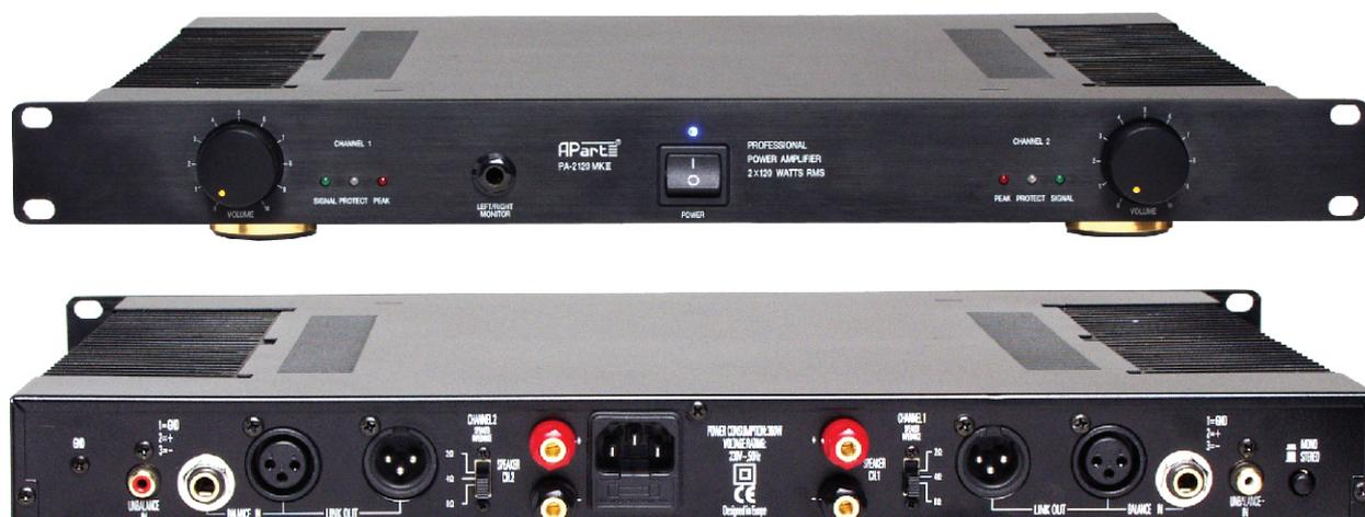
Cet amplificateur de puissance stéréo 19" est très compact et vous fournit 2 x 120 watts sous 2, 4 ou 8 ohms. Il est ainsi possible de brancher jusqu'à 8 enceintes 16 ohms en parallèle par canal d'amplificateur. L'impédance doit être sélectionnée à l'arrière de l'amplificateur au moyen du sélecteur d'impédance.
