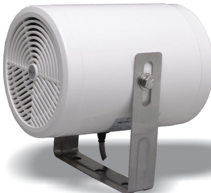
Le MPBD15 APart est un très élégant projecteur de son bidirectionnel à double cône équipé d'un transformateur 15 watts sous 100 volts de haute qualité et de 2 woofers 5,25" à double cône. Son fonctionnement bidirectionnel adapte très bien le MPBD15 à l'emploi dans des corridors et autres lieux larges/longs (par ex. terminal d'aéroport, gare, ...).
