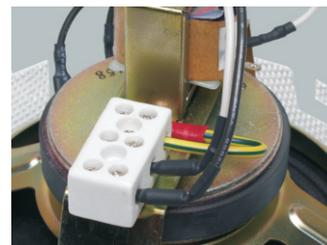
Le CM6SF Apart est un haut-parleur double cône intégré à un dôme en métal anti-incendie. Le haut-parleur est fourni avec un connecteur en céramique et un fusible thermique. Cela destine particulièrement bien le CM6SF aux applications d'évacuation. Le CM6SF est en conformité avec la législation européenne (En60849).
