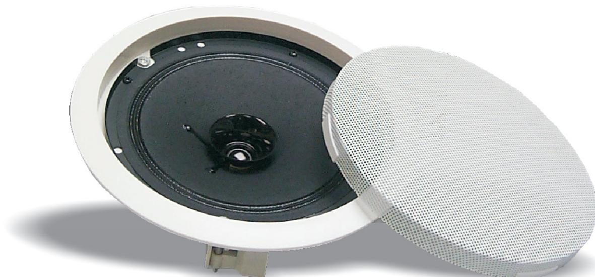
Le CM6E Apart est un haut-parleur de plafond 100 V à double cône équipé d'un transformateur 100 volts de haute qualité avec plusieurs réglages de puissance. Le CM6E convient très bien à la distribution d'appels au microphone, de messages publicitaires et d'évacuation.
