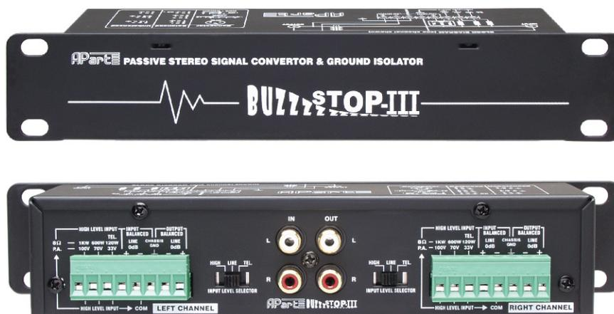
Le BUZZSTOP-MKIII APart est un adaptateur d'entrée universel qui peut être employé pour toutes les connexions et rallonges. Le sélecteur de niveau d'entrée vous permet de convertir toute sortie d'amplificateur en n'importe quelle sortie de niveau ligne, symétrique ou asymétrique (par ex. : vous pouvez convertir un signal de haut-parleur 100 V en signal de niveau ligne symétrique ou asymétrique).
