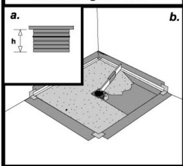
a. **Recouper** si nécessaire le support de grille à hauteur avant sa mise en place.
