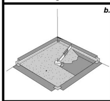
a. **Réaliser** directement sur la feuille ISOTANCHE, la chape de carrelage d'environ 3 à 4 cm en respectant une pente d'écoulement.
