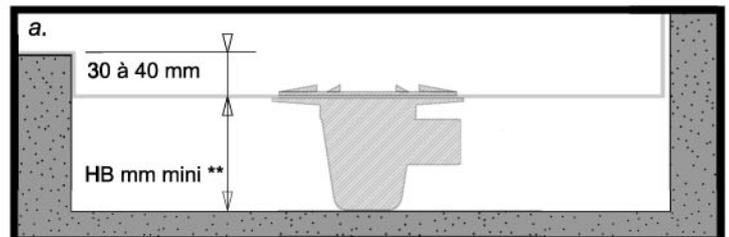
2. Former une pente vers la bonde, réserver l'emplacement de la bonde et de son tube d'évacuation.
