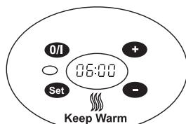
De stekker van het apparaat zit in het stopcontact en de standaardkooktijd is weergegeven.
