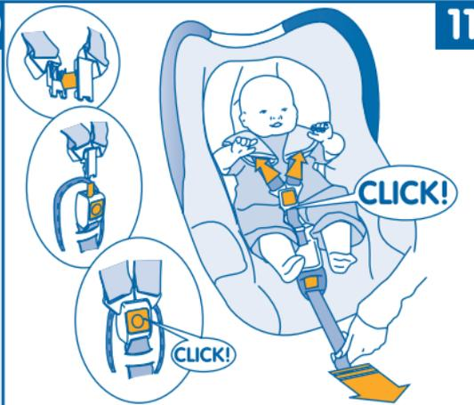
11 - Setzen Sie Ihr Kind in die Schale, führen Sie dann die Gurte zusammen und führen Sie diese mit einem Klick, welcher das Einrasten bestätigt, ins Gurtschloss ein. Passen Sie den Hosenträgergurt an das Kind an, indem Sie am Gurt zum Straffen des Hosenträgergurtes ziehen.
