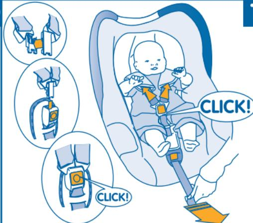
11 - Instalar al bebé y unir las dos partes metálicas que componen la hebilla. Introduzca la hebilla en el cierre del amés. El clic indica que está bien anclado. Después ponga el conjunto dentro del sistema de cierre del amés. Un clic le indica que está bien anclado. Ajustar el amés a la talla del bebé tirando de la cinta de regulación.
