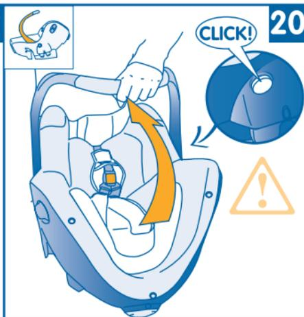
20 - Cuando el asa alcance la posición de transporte deberá oírse un clic y el botón de bloqueo volverá a la posición original. Esto indica que el asa ha quedado correctamente bloqueada. **IMPORTANTE** : antes de desplazar la silla, asegúrese de que el asa de transporte esté correctamente bloqueada.
