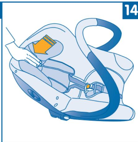
14 - Appuyer sur la tête vers l'arrière pour bloquer en position sélectionnée.
