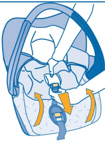
28 - Déhousser le bas du siège et passer la boucle du harnais à travers la fente de la housse.
