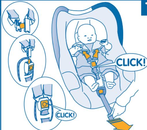
11 - Plaats uw kindje in de autostoel, plaats de gordel delen op elkaar en sluit de gordel. Als u een duidelijke klik hoort is de gordel goed gesloten. Span de gordel aan door aan de aanspanningsriem te trekken. **ATTENTIE** : Sluit de gordel in elke omstandigheid.
