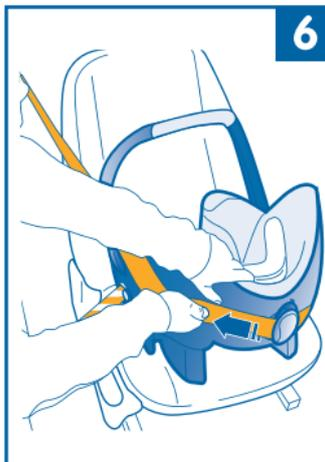
6 - Una vez el cinturón diagonal esté correctamente colocado en la guía-pasaje, tensar el cinturón.
