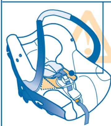
9 - Ihr Kinderrückhaltesystem ist mit einem Sitzverkleinerungskissen ausgerüstet, das unten an der Kopfstütze mit 2 sich hinter der Kopfstütze befindlichen Druckknöpfen befestigt wird.
