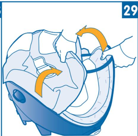
29 - Déhousser le haut du siège et dégager les élastiques passant derrière le polystyrène.
