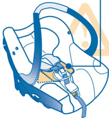
9 - Este dispositivo de retención infantil está equipado con un cojín reductor bajo el reposacabezas, fijado con dos clips de sujeción. **ATENCIÓN** : Utilizar el cojín reductor desde el nacimiento hasta 3 meses de edad máx., siempre, con el reposacabezas en la posición más baja.
