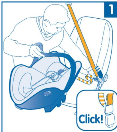
**ACHTUNG :** Lesen Sie vor dem Einbau des Sitzes diese Gebrauchsanweisung vollständig durch. Die blauen Markierungen zeigen Ihnen die Gurtführung des Sicherheitsgurts des Fahrzeugs. Bei Verwendung als Autositz muss der Tragegriff von Créatis.fix unbedingt hochgeklappt werden.
