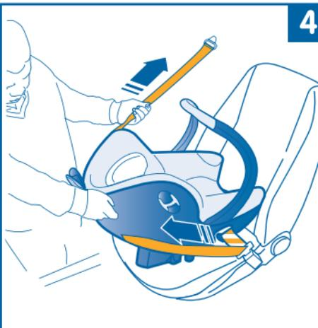
4 - Faites passer la ceinture d'épaule derrière la coque, puis tirez-la fermement afin de tendre la ceinture ventrale, et de plaquer le siège de retenue pour enfants sur l'assise du siège du véhicule
