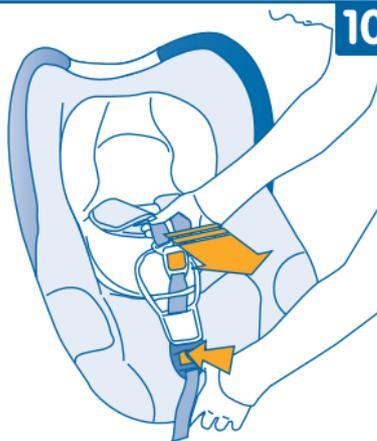
10 - Verlängern Sie die Gurte des Hosenträgergurtes, in dem Sie auf die Klappe des zentralen Gurtstraffers drücken und an den Gurten ziehen.
