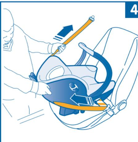
4 - Pasar el cinturón diagonal por detrás de la carcasa, después tirar firmemente para tensar el cinturón y fijar así la silla de auto al asiento del automóvil.
