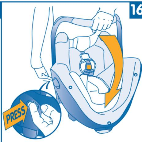
16 - Appuyer sur le bouton de verrouillage gauche de la poignée, tout en maintenant la pression basculer la poignée vers l'arrière.
