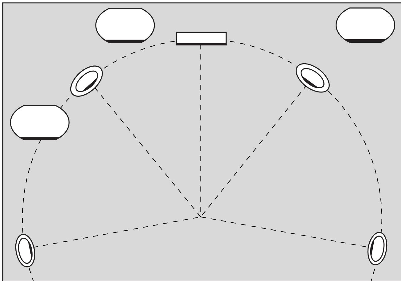
② Positionnement des colonnes LINEA et du caisson de graves LARGO
