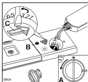
A l'aide de la pointe d'un couteau (ou d'un tournevis), augmentez graduellement la dose si vous observez sur la vaisselle des gouttes d'eau ou des taches de calcaire; diminuez la dose au contraire si vous notez la présence de rayures blanchâtres.
