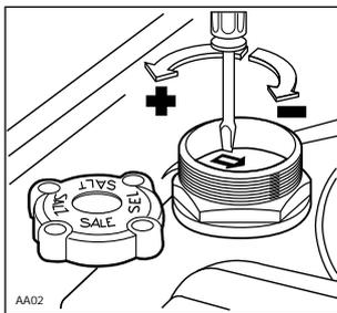
enlevez le panier inférieur, dévissez et ôtez le bouchon du réservoir de sel placé sur le fond de la cuve; à l'aide d'un tournevis ou d'un couteau tournez le sélecteur à deux positions de la position - à la position +.
