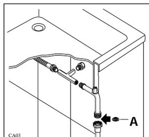
Branchez le tuyau à un robinet avec un raccord de 3/4" ou à une prise d'eau à branchement rapide (press block).
