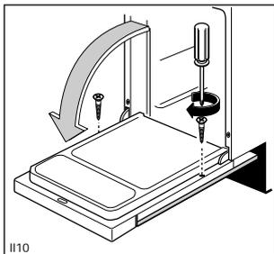
Soulevez le panneau au niveau du bandeau de commande: la position optimale une fois atteinte, ouvrez la porte et fixez le panneau à l'aide de deux vis 4x40 en utilisant les trous de la contreporte.
