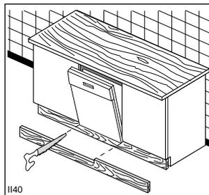
Pour permettre l'ouverture complète de la porte il pourrait être nécessaire de découper le socle du meuble.
