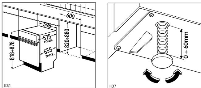
La hauteur de l'appareil peut varier de 6 cm grâce aux pieds réglables. Réglez la hauteur de l'appareil entre 820 et 880 mm en agissant sur les pieds réglables.
