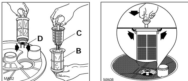
Une fois le nettoyage effectué, réinsérez les filtres en les poussant jusqu'à ce qu'ils soient bien engagés dans leur logement.
