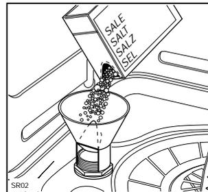
A l'aide de l'entonnoir prévu à cet effet, remplissez le réservoir avec 1,5÷1,8 kg environ de sel spécial pour lave-vaisselle. Revissez soigneusement le bouchon en vous assurant qu'il n'y ait pas de résidus de sel sur le filetage et sur le joint.
