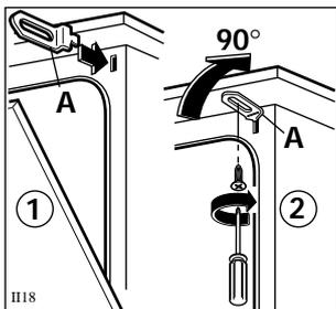
Introduisez les deux équerres dans les trous prévus à cet effet sur la partie avant du lave-vaisselle et tournez-les de 90°. Fixez-les au plan de travail à l'aide de deux vis 3,5x16.
