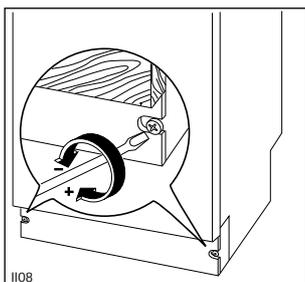
Dans ce but utilisez les vis situées sur le socle de l'appareil. Si, en maintenant la porte entrouverte, vous vissez ou dévissez ces vis, la tension des ressorts de balancement de la porte augmente ou diminue.
