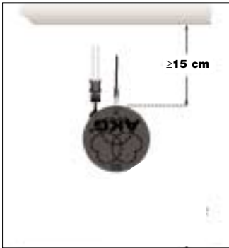
Abb. 7: Mindestabstand von der Decke
