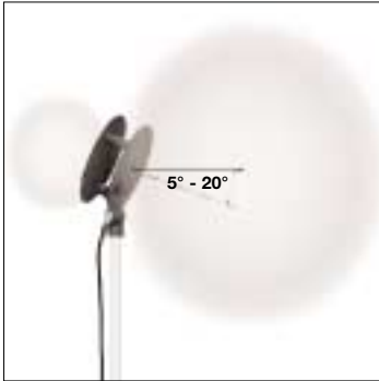
Fig. 4 : Caractéristique de directivité hypercardioïde
