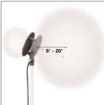
Fig.4: Característica direccional hipercardioide
