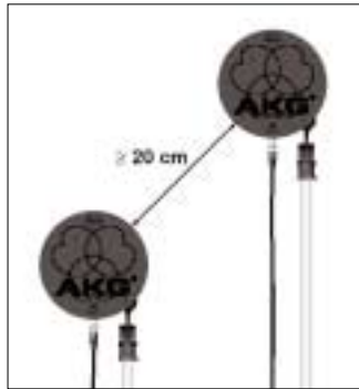
Fig. 8: Distância mínima entre duas antenas
