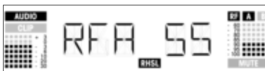
Ejemplo 2: La antena A estuvo activa el 55% del tiempo de verificación. Máximo nivel de audio: -3 dB. Mínima intensidad de campo en la antena A: -90 dB.
