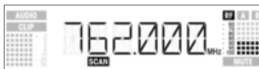
Exemple 1: La fréquence de réception de 762 MHz affiche un niveau de bruit de -90 dB.
