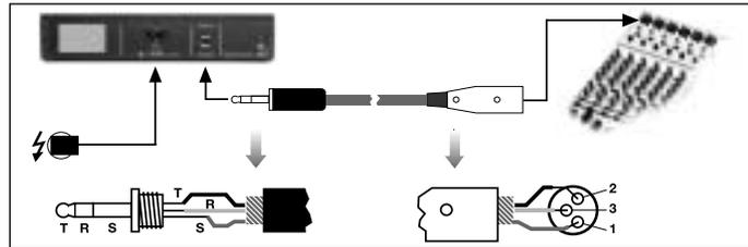
Fig. 3: Collegamento ad un ingresso simmetrico
