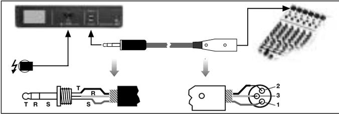
1. Se necesita un cable balanceado con conector XLR y un jack TRS de 6,3 mm (que se puede comprar en el comercio especializado para electrónica o HiFi).
