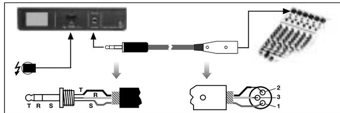
Fig. 4: Collegamento ad un ingresso asimmetrico
