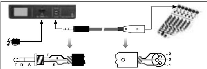
1. Con un cable jack de 6,3 mm empalme la toma AUDIO OUT en la placa posterior del receptor con una entrada LINE desbalanceada (jack de 6,3 mm) en el pupitre mezclador o amplificador.
