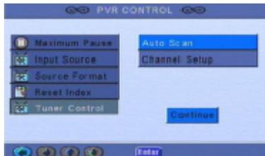
3. Choisir 'AUTO SCAN' (recherche automatique) et appuyer sur **ENTER** pour confirmer, il y'aura une indication pour poursuivre à l'écran, aussi re-appuyer sur enter pour re-confirmer la recherche automatique. Pendant la recherche automatique, une barre bleue indiquera la progression de la recherche de gauche à droite.
