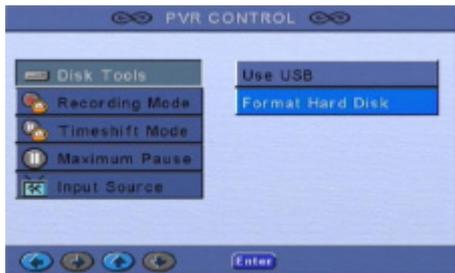
Dans le menu SETUP SYSTEM, choisir l'option PVR CONTROL, puis « Format Hard Disk » dans l'option DISK TOOLS (En mode DVD, le formatage n'est pas possible). Une fois validé, une indication sera affichée à l'écran. Appuyer sur
