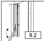
Tirer la broche de blocage en position A avant d'ouvrir la porte (fig. 8.1). Ouvrir la porte avec la main froide (fig. 8.2). Nettoyer la vitre du foyer. Refermer la porte du foyer et pousser la broche en position B (fig. 8.1).
