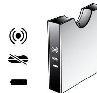
Alle Anzeigen blinken, anschließend leuchtet Akku-Ladeanzeige permanent
