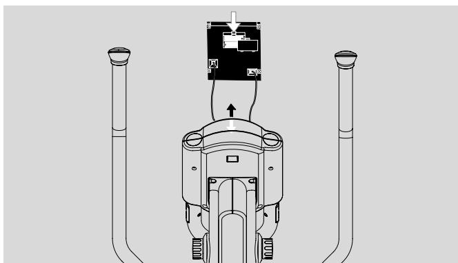
Eine schwache oder erloschene Computeranzeige macht einen Batteriewechsel erforderlich. Der Computer ist mit zwei Batterien ausgestattet. Nehmen Sie den Batteriewechsel wie folgt vor:
