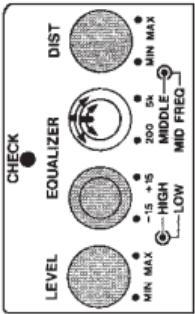
**7. Ajustez la tonalité des basses fréquences avec la commande de niveau des graves. La tourner dans le sens des aiguilles d'une montre amplifie les basses fréquences tandis que la tourner en sens inverse les atténue.**
