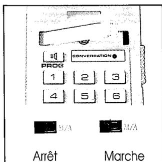
*Mettez l'interrupteur M/A (Marche/Arrêt) du combiné, situé sous le plexiglas, sur la position M (Marche) et remettez le plexiglas en place. Déployez complètement l'antenne de la base et*
