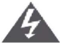
Le symbole en forme d'éclair fléché inscrit dans un triangle équilatéral est destiné à avertir l'utilisateur de la présence à l'intérieur de l'appareil d'une <<tension dangereuse>> non isolée qui peut être suffisamment puissante pou présenter un risque d'électrocution pour les personnes.
