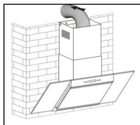
Connectez le tuyau flexible à la sortie d'aération. L'installation est maintenant terminée.
