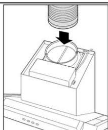
Attachez le tuyau d'échappement flexible
