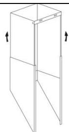
Insérez la partie supérieure de la cheminée avec la partie inférieure. Puis tirez la partie supérieure vers le haut. Ajustez approximativement la hauteur de la cheminée. Un réglage plus précis peut être fait plus tard.
