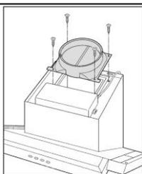
Assemblez l'unité en fixant la valve de sortie au-dessus du compartiment du moteur avec 4 vis de 4 x 8 mm
