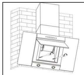
Ouvrez le compartiment du filtre et insérez 2 vis de 4 x 30mm à l'ancrage de sécurité.
