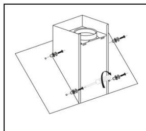
Fixez le toit en appliquant 4 sets de "vis à tête plate + bague en aluminium + tampon en caoutchouc"
