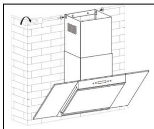
Insérez la partie supérieure de la cheminée et fixez-la au mur avec 2 vis de 4 x 8mm.
