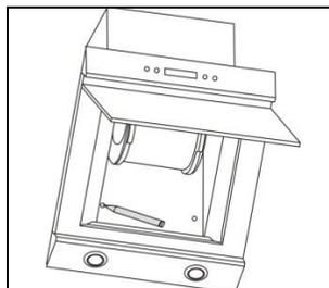
Ouvrez le filtre et marquez les deux trous d'ancrage sur le mur derrière l'unité
