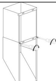
Assemblez la plaque murale de la partie inférieure de la cheminée avec 2 vis 4 x 8 mm. Souvenez-vous de ne pas resserrer la vis, de sorte que plus tard, le réglage en hauteur peut être effectué facilement.
