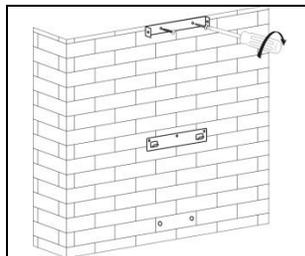
Positionnez la plaque murale de la partie supérieure de la cheminée et fixez-la au mur avec 2 vis de 4 x 40mm
