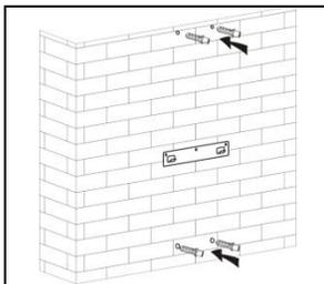
Insérez les chevilles dans les trous percés pour l'ancrage de la partie supérieure de la cheminée.
