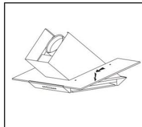
Installez le toit en verre en le faisant glisser. Pour sécuriser le toit en verre, assurez-vous que la protection est attachée à l'avant.
