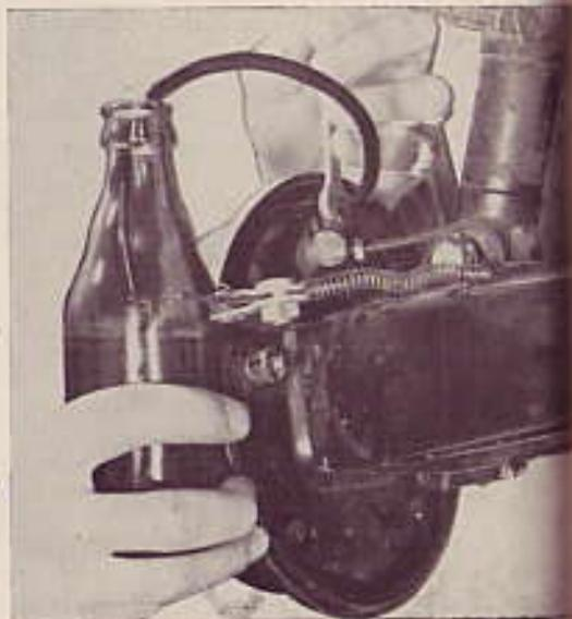
tuer la purge, vérifier la garde de la pédale (voir plus loin), et le niveau du réservoir Lockheed. Commencer à purger par le cylindre récepteur le plus loin du maître cylindre, et terminer par le plus près, (AR droit, AR gauche ; AV droit, AV gauche).
