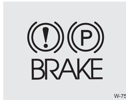
Vérifiez le témoin d'alerte des freins en tournant la clé de contact sur ON (sans faire démarrer le moteur). Le témoin s'allumera si le frein de stationnement est engagé quand la clé de contact se trouve sur ON ou START.
