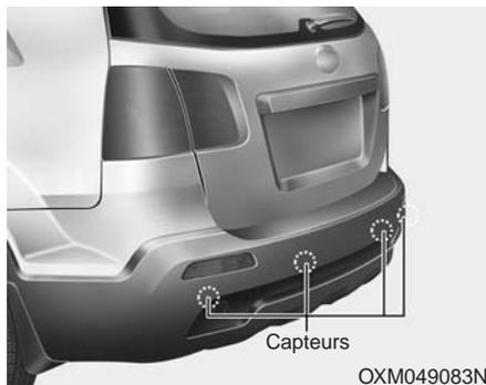
Le système d'assistance de stationnement à reculons aide le conducteur lors de la marche arrière du véhicule en faisant retentir un carillon en cas de la détection de tout objet situé à moins de 120 cm (47 po) derrière le véhicule.
