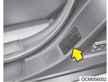
L'étiquette de certification de véhicule apposée sur le pilier central du côté du conducteur possède le numéro d'identification du véhicule (NIV).
