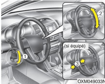
Pour modifier l'angle du volant, abaissez le levier de blocage (1), ajustez le volant à l'angle (2) et à la hauteur (3, si équipé) désirés puis relevez le levier de blocage afin de verrouiller la colonne de direction en position. Assurez-vous d'ajuster le volant avant de conduire.
