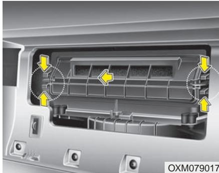
3. Retirez le boîtier du filtre à air de climatisation en tirant sur les deux côtés du couvercle.
