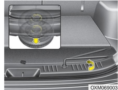
3. Utilisez la clé à écrous pour desserrer le bouton et abaisser la roue de secours. Tournez la clé dans le sens antihoraire jusqu'à ce que le roue de secours touche le sol.
