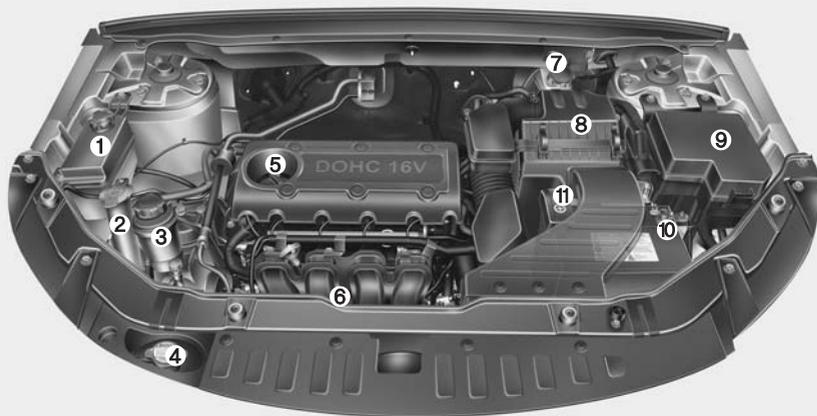
1. Réservoir du liquide de refroidissement
