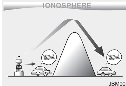
Les diffusions en AM peuvent être captées sur de plus grandes distances que les diffusions en FM. Ceci provient du fait que les ondes radio AM sont transmises à basses fréquences. Ces longues ondes radio de basse fréquence peuvent suivre la courbe de la Terre plutôt que se déplacer en ligne droite dans l'atmosphère. De plus, elles suivent la forme des obstructions, offrant ainsi une meilleure couverture.
