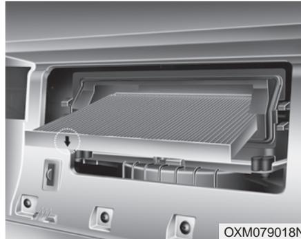
4. Remplacez l'élément filtrant.
