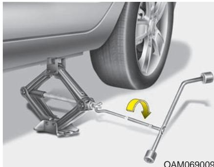
8. Insérez la manivelle dans le vérin et tournez-la dans le sens horaire pour soulever le véhicule jusqu'à ce que la roue soit soulevée du sol d'environ 3 cm (1 po).
