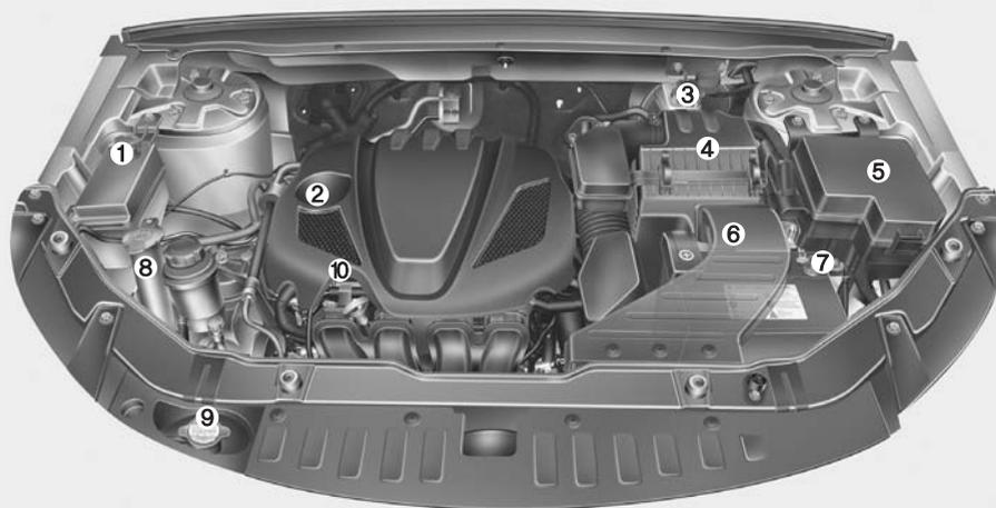
1. Réservoir du liquide de refroidissement
