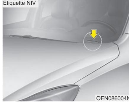
Le NIV est également inscrit sur une plaque fixée sur le dessus du tableau de bord. On peut facilement voir le numéro sur la plaque depuis l'extérieur à travers le pare-brise.
