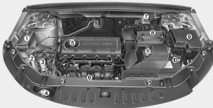
1. Réservoir du liquide de refroidissement.....7-20
