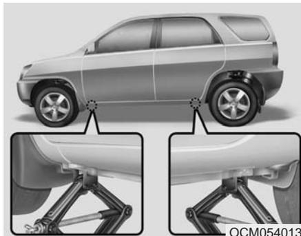
7. Placez le vérin à la position avant ou arrière la plus près de la roue à changer. Placez le vérin à la position désignée sur le châssis.
