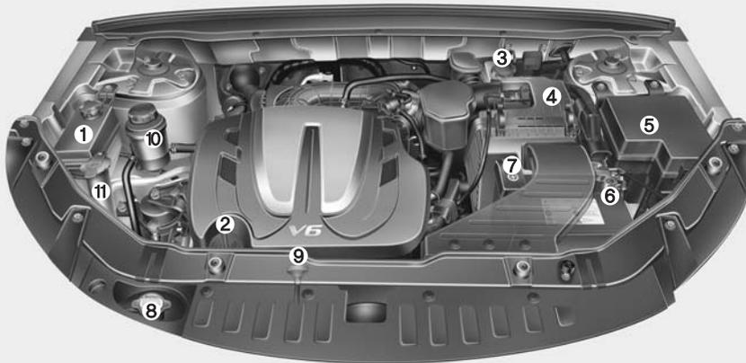
1. Réservoir du liquide de refroidissement
