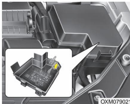
3. Tirez le fusible suspect bien droit en utilisant l'outil de retrait qui se trouve sur le couvercle du panneau des fusibles.
