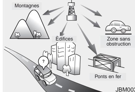
Les diffusions en FM sont transmises à haute fréquence et ne suivent pas la surface de la Terre. De ce fait, les diffusions FM commencent généralement à faiblir, à courte distance de la station.
