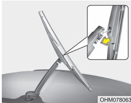
2. Installez le nouveau balai en insérant la partie centrale dans la fente du bras d'essuie-glace jusqu'à ce qu'il s'encliquète en place.
