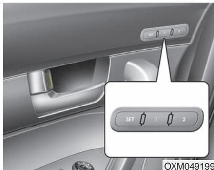
La mémoire de position du siège du conducteur permet de stocker et de rappeler la position du siège du conducteur, du rétroviseur extérieur et du volant ou du niveau d'illumination du tableau de bord par simple pression d'un bouton. En mémorisant ces positions, plusieurs conducteurs peuvent effectuer un repositionnement en fonction de leurs préférences. Si la batterie est déconnectée, la mémoire est effacée.
