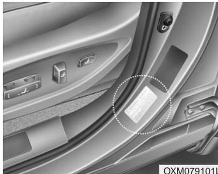
Toutes les spécifications (grandeurs et pressions) se trouvent sur une étiquette apposée sur le pilier central, du côté conducteur.
