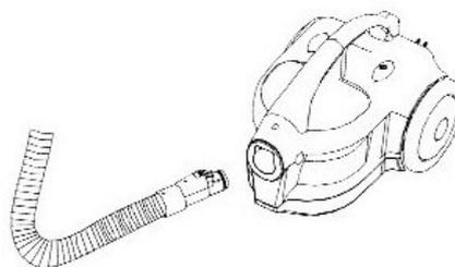
Emboîter le tube télescopique au flexible :
