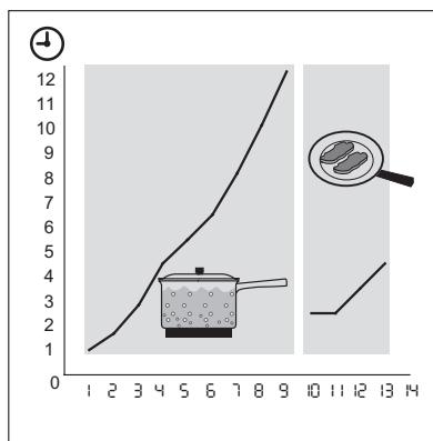
Bei Aktivierung der Ankochautomatik wird die gewünschte Kochstufe in kürzerer Zeit erreicht. Bei Verwendung dieser Funktion wird für eine bestimmte Zeit (siehe Grafik) die höchste Kochstufe eingestellt und dann auf die erforderliche Kochstufe zurückgeschaltet. So aktivieren Sie die Ankochautomatik für eine Kochzone:
