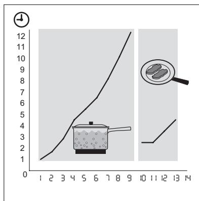
Il est possible d'atteindre rapidement le niveau de cuisson désiré en activant la fonction de Démarrage automatique de la cuisson. Cette fonction permet d'atteindre le niveau de cuisson le plus élevé pendant un certain temps (voir le graphique) puis de descendre progressivement au niveau de cuisson souhaité.
