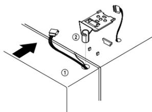
**3** Visser le système de fixation de la charnière de plusieurs tours. Connecter les faisceaux électriques et visser le fil de terre.
