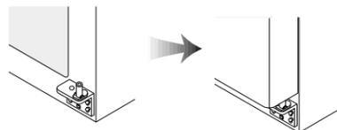
**2** Refermer la porte et insérer l'ergot de la charnière du haut dans le trou du haut de la porte du réfrigérateur. (Insérer d'abord l'arrière de la charnière dans la rainure de l'élément saillant, puis la faire rentrer dans le trou du haut de la porte.)
