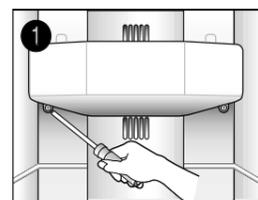
1 Enlever les cache-vis en dessous du boîtier d'éclairage avec un petit tournevis
