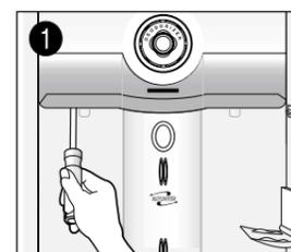
1 Enlever les cache-vis en dessous du boîtier d'éclairage avec un petit tournevis
