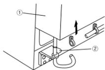
**2** Refermer la porte et insérer l'ergot de la charnière du haut dans le trou du haut de la porte du congélateur. (Insérer d'abord l'arrière de la charnière dans la rainure de l'élément saillant, puis la faire rentrer dans le trou du haut de la porte.)
