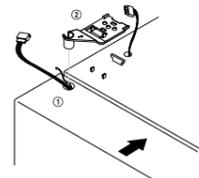
**3** Visser le système de fixation de la charnière de plusieurs tours. Connecter les faisceaux électriques et visser le fil de terre.
