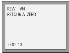
Le magnétoscope rembobinera la cassette jusqu'à la position zéro et s'arrêtera.
