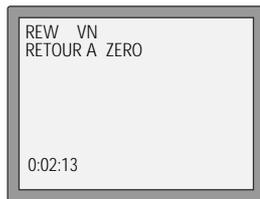
Le magnéscope bobine la cassette jusqu'à la position 0:00:00 du compteur et s'arrête.
