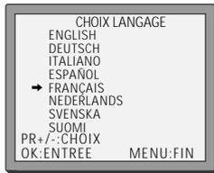
Affichez menu principal du magnétoscope, sélectionnez REGLAGE MAGNETOSCOPE, puis CHOIX LANGAGE.
