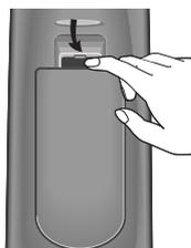
Insérez les piles dans le compartiment comme indiqué sur le schéma.
