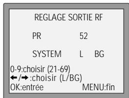
Lancez le menu principal et sélectionnez « Réglage Magnétoscope », puis « Réglage Sortie RF ».
