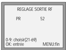
Lancez le menu principal et sélectionnez « Réglage Magnétoscope », puis « Réglage Sortie RF ».
