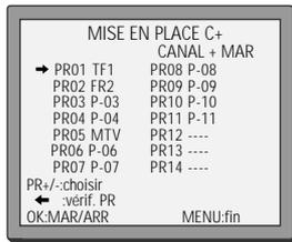
Pour Canal+ << Mise en Place C+>> doit être réglé sur "Canal+ MAR" pour être reconnu en tant que chaîne Canal+.
