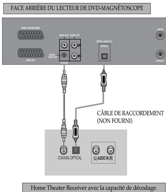
**1** Raccordez le lecteur à l'amplificateur Dolby Digital par un câble coaxial ou optique (prises COAXIAL ou OPTICAL).
