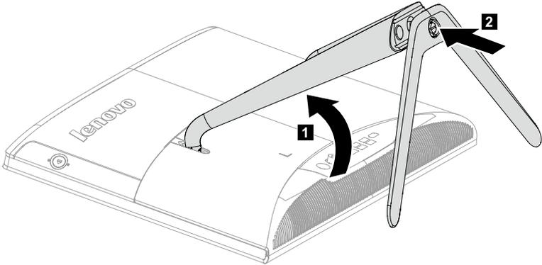
3. Tirez l'anneau de la vis manuelle, puis fixez la base du socle sur le support du socle à l'aide de la vis manuelle. **3**
