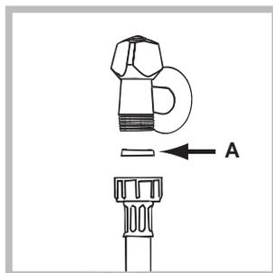
2. Monter le joint A, fourni dans le sachet, sur l'extrémité du tuyau d'arrivée de l'eau et le visser à un robinet d'eau froide à embout fileté 3/4 gaz (voir figure).
