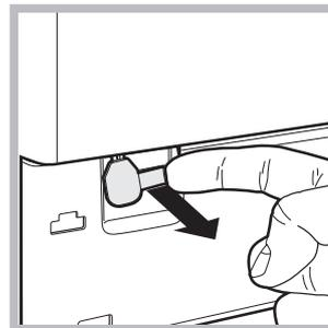
4. se servir de la languette indiquée, tirer vers soi jusqu'à ce que le tirant en plastique se dégage de son cran d'arrêt; tirer ensuite vers le bas jusqu'à ce qu'un "click" indique que la porte est déverrouillée.
