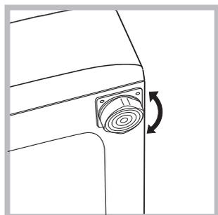
2. Pour compenser les irrégularités du sol, visser ou dévisser les pieds de réglage jusqu'à ce que l'appareil soit parfaitement à l'horizontale (il ne doit pas être incliné de plus de 2 degrés).
