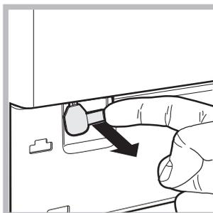
4. se servir de la languette indiquée, tirer vers soi jusqu'à ce que le tirant en plastique se dégage de son cran d'arrêt; tirer ensuite vers le bas jusqu'à ce qu'un "clac" indique que la porte est déverrouillée.
