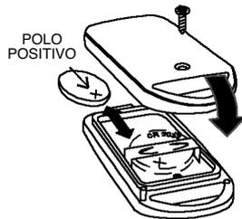
Para la sustitución utilizar baterías al Litio modelo CR 2032 3V (COD. 222120050).
