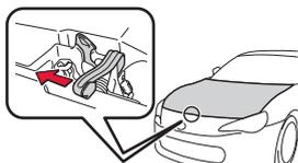
2. À l'avant du véhicule, poussez le levier du verrou secondaire vers la gauche puis soulevez le capot moteur.
