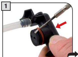
Retirer le joint torique à l'aide d'un objet pointu.
