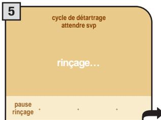
L'appareil procède au rinçage. Une fois le rinçage terminé, il faut remplir le réservoir avec de l'eau fraîche potable. Avant de remplir le réservoir, si on le désire, monter à nouveau le filtre à eau ; autrement, réintroduire le petit filtre blanc (voir page 7).
