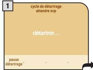
L'appareil commence à distribuer le produit détartrant à travers la buse d'eau chaude. La distribution du produit détartrant s'effectue à des intervalles prédéfinis ; de cette manière, le produit détartrant peut agir efficacement.
