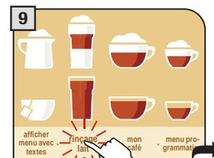
L'appareil propose de nettoyer les circuits lait. La touche clignote. Appuyez sur « rinçage lait » pour effectuer le nettoyage des circuits internes.
