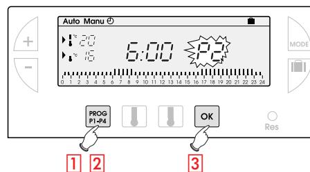
**1** Drücken Sie die Taste **PROG P1-P4** um in die Betriebsart Programmierung zu gelangen. Die Nummer des Programms, die dem Wochentag zugeordnet ist, blinkt im rechten Teil des Displays.
