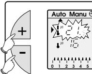
L'indicatore del livello di temperatura in corso (comfort o economia), si mette a lampeggiare. La modifica terminerà al prossimo cambio di temperatura programmato.
