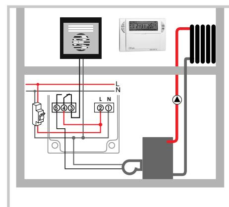
! Falls Sie den Thermoflash DIGI 24 HF für Heizung und Kühlung Steuerung verwenden, müssen Sie achten, dass beide Systeme (Heizung und Kühlung) nicht während der selbe Jahreszeit funktionieren.
