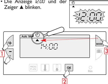
**1** Stellen Sie nun mit den Tasten **+-** die Uhrzeit ein. Beim anhaltenden Drücken dieser Tasten läuft die Zeitanzeige schneller durch.
