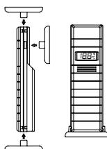
L'émetteur est fourni avec un support qui peut être fixé à un mur au moyen des deux vis fournies.
