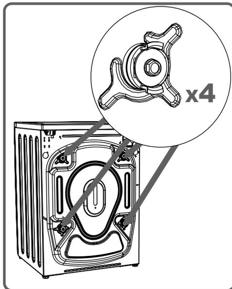
Dévissez les vis dans le sens inverse des aiguilles d'une montre à l'aide d'une clé appropriée (non fournie).
