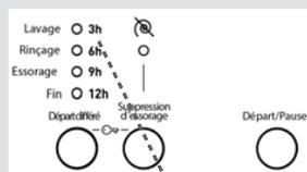
Pour exécuter la fonction de départ différé, votre appareil doit être mise en fonctionnement en appuyant sur le bouton Départ/Pause.
