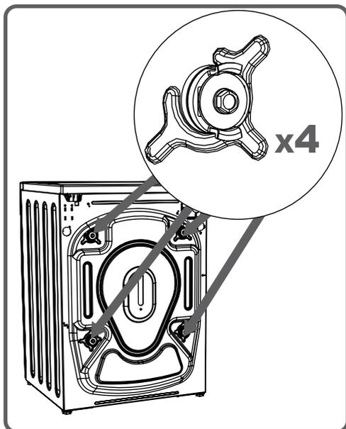
Pour cette raison, les vis de bridage transport doivent être dévissées par rotation dans le sens contraire aux aiguilles d'une montre à l'aide d'une clé appropriée. (clé non-fournie).
