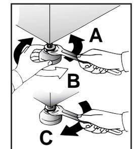
Note: nous vous recommandons de conserver le support et les vis de transit pour protéger la machine en cas de déplacement ultérieur. Les fabricants déclinent toute responsabilité en cas de détérioration de la machine résultant du non-respect des instructions sur la dépose de la protection de transit.
