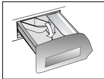
Ce bac doit être introduit dans la section "2" du tiroir à lessive, également lorsque l'on désire utiliser le programme "RINÇAGES" comme cycle de BLANCHISSAGE.
