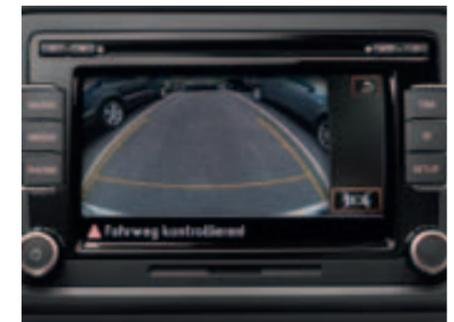
L'écran de la radio affiche l'image de la caméra de recul „RearAssist“<sup>1)</sup>. La vue d'ensemble de l'arrière du véhicule permet de se garer mieux et plus facilement. Même les manœuvres avec une remorque s'en trouvent facilités
