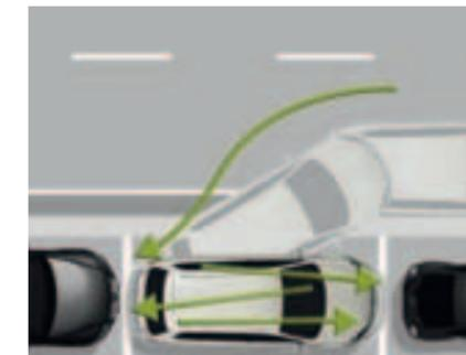
Le système d'aide au stationnement en créneau „ParkAssist“ gare automatiquement la nouvelle Golf SW. Le volant tourne tout seul, il vous reste à gérer les pédales. L'assistant fonctionne lorsque la place de parking mesure 1,10 mètre de plus que le véhicule.
