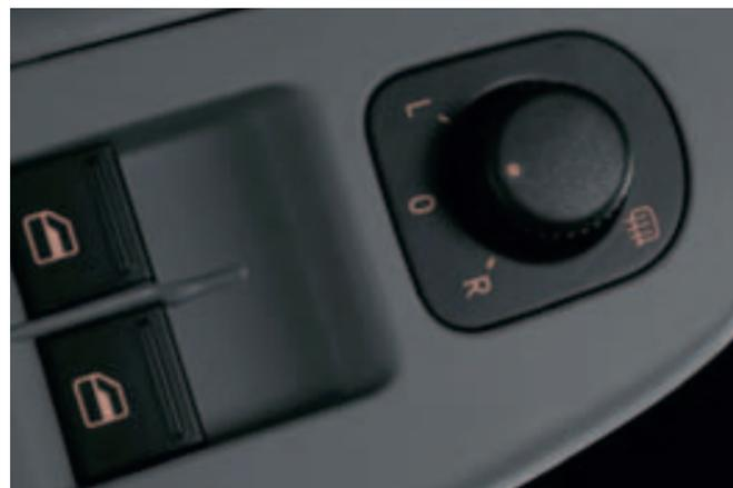
Rétroviseurs électriques et dégivrants. Vitres avant et arrière électriques.
