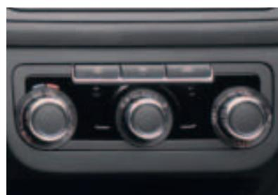
La climatisation semi automatique 'Climatic' à régulation de température automatique.
