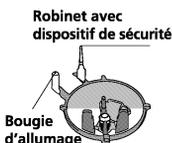
En cas de problème d'allumage au niveau des brûleurs supérieurs, le dispositif de sécurité coupe immédiatement l'arrivée du gaz. Ce dispositif est
