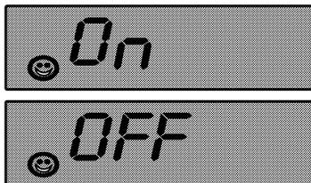
Si le bouton de la fonction four est réglé sur une position autre que "0" (Arrêt) alors que le verrouillage des touches est activé, votre four ne fonctionnera pas.
