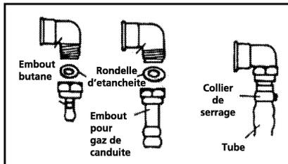
L'embout butane permet le raccordement par tube souple en caoutchouc de diamètre intérieur de 6 mm destiné aux gaz distribués par bouteilles. L'embout pour gaz de conduite permet le raccordement par tube souple de diamètre intérieur de 15 mm, le tube devant être enfoncé suffisamment pour permettre son maintien obligatoire par un collier de serrage.
