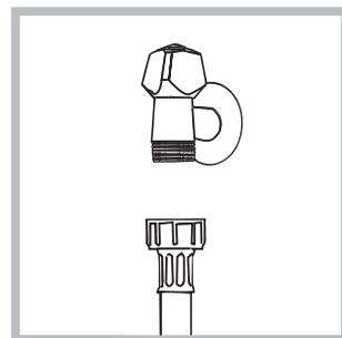
2. Sluit de toevoerbuiss aan op de koudwaterkraan met een mondstuk met schroefdraad van 3/4 gas (zie afbeelding). Voordat u de wasautomaat aansluit moet u het water laten lopen totdat het helder is.
