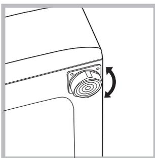
2. Compense las irregularidades desenroscando o enroscando las patas hasta que la máquina quede en posición horizontal (no debe estar inclinada más de 2 grados).
