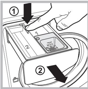
Verwijder het laatje door op het hendeltje (1) te drukken en het naar voren te trekken (2) (zie afbeelding). Was het onder stromend water. Dit moet u regelmatig doen.
