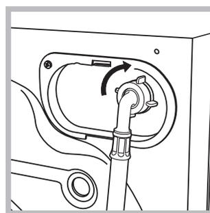
1. Ligue o tubo de alimentação na máquina de lavar roupa atarraxado no apropriado fornecimento de água, na parte traseira, em cima à direita (veja a figura).
