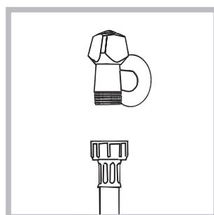
2. Schrauben Sie den Wasserschlauch an einen Kaltwasserhahn mit 3/4-GAS-Gewindeanschluss an (siehe Abb.).
