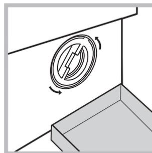
2. Nehmen Sie einen Behälter zum Auffangen des auslaufenden Wassers (ca. 1,5 Liter) zur Hand (siehe Abbildung);
