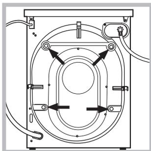
2. Tire os 4 parafusos de protecção para o transporte e o respectivo calço, situados na parte traseira (veja a figura).
