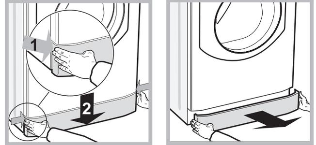
1. verwijder het afdekpaneel aan de voorzijde van de wasautomaat door er op het midden op te drukken. Duw beide zijanten naar beneden toe en verwijder het paneel (zie afbeeldingen).
