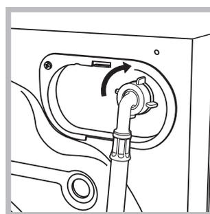
1. Schließen Sie das andere Ende des Schlauches an den oben rechts am Rückteil des Gerätes befindlichen Wasseranschluss an (siehe Abbildung).
