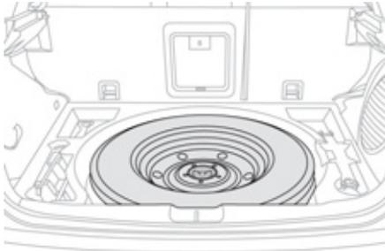
La roue de secours est installée dans le coffre sous le plancher.
