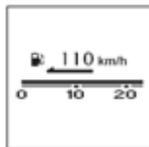
**Moteur tournant**, elle indique le nombre de kilomètres pouvant être encore parcourus avec le carburant restant dans le réservoir en fonction de la consommation moyenne des derniers kilomètres parcourus.
