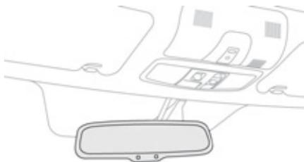
Grâce à un capteur, mesurant la luminosité provenant de l'arrière du véhicule, ce système assure automatiquement et progressivement le passage entre les utilisations jour et nuit.
