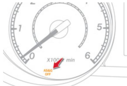
En cas de dysfonctionnement du système, le témoin «AS&G OFF» clignote au combiné ou dans l'afficheur du combiné, et le système ne fonctionne plus.
