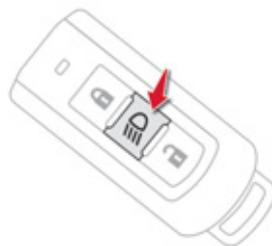
Cette commande ne fonctionne que **contact coupé** et commande d'éclairage en position «**OFF**» ou «**AUTO**».
