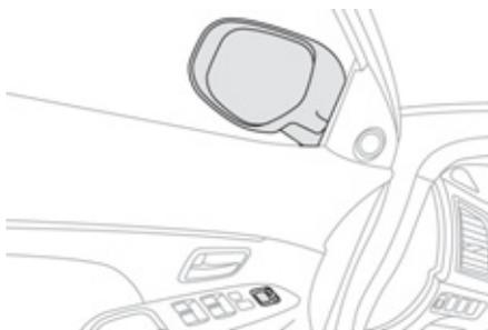
Équipés chacun d'un miroir réglable permettant la vision arrière latérale nécessaire aux situations de dépassement ou de stationnement. Peuvent également être rabattus pour stationner dans un passage étroit.
