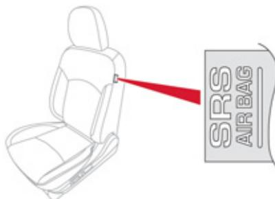
Système protégeant, en cas de choc latéral violent, le conducteur et le passager avant afin de limiter les risques de traumatisme au thorax. Chaque airbag latéral est intégré dans l'armature du dossier de siège avant, côté porte.
