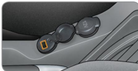
Le port USB est situé dans le boîtier «AUX» sur la console centrale.
