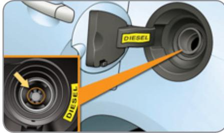
Dispositif mécanique pour empêcher le remplissage de carburant essence dans le réservoir d'un véhicule fonctionnant au gazole. Il évite ainsi toute dégradation moteur liée à ce type d'incident.
