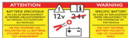
La présence de cette étiquette, notamment avec le Stop & Start, indique l'utilisation d'une batterie au plomb 12 V de technologie et de caractéristiques spécifiques, qui nécessite, en cas de remplacement ou de débranchement, une intervention du réseau CITROËN ou d'un atelier qualifié.
