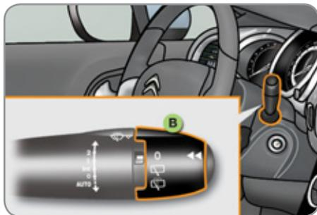
**B.** Bague de sélection de l'essuie-vitre arrière :
