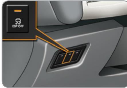
☞ Appuyez sur le bouton «ESP OFF», situé à proximité du volant.
