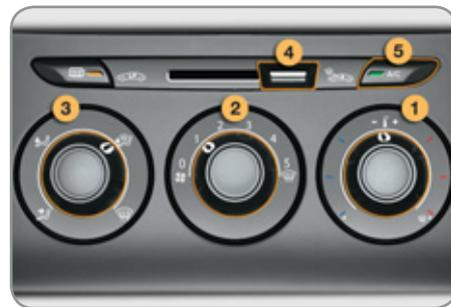
Les systèmes de chauffage / ventilation ou d'air conditionné fonctionnent moteur tournant, ainsi qu'en mode STOP du Stop & Start.
