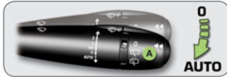
Elle est commandée manuellement par le conducteur en donnant une impulsion sur la commande **A** vers la position «**AUTO**».
