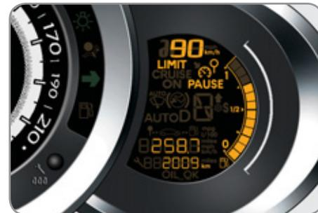
Le mode régulateur ou limiteur de vitesse apparaît dans le combiné quand celui-ci est sélectionné.
