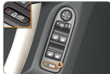
L'allumage du voyant A vous signale la neutralisation des commandes de portes et des lève-vitres électriques arrière.
