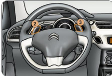
Boîte de vitesses manuelle pilotée à cinq ou six vitesses offrant, au choix, le confort de l'automatisme ou le plaisir du passage manuel des vitesses.
