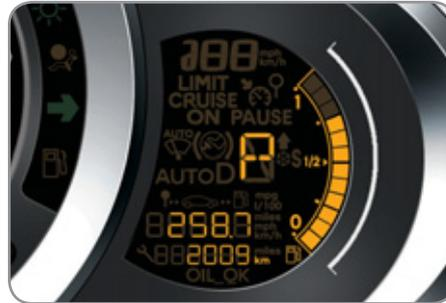
Le mode de conduite sélectionné et/ou le rapport de vitesse engagé apparaissent dans l'afficheur du combiné.
