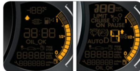
L'information apparaît sous la forme d'une flèche dans l'afficheur du combiné.
