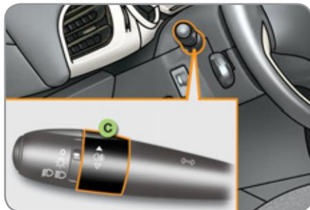
**C.** Bague de sélection des feux antibrouillard.
