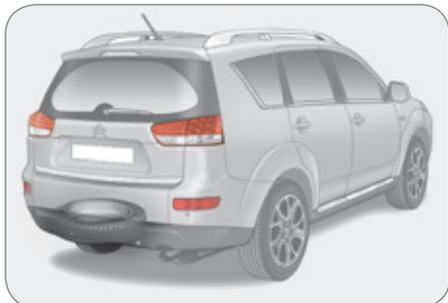
La roue de secours de type «tôle» est installée à l'extérieur, sous le coffre, maintenue par un treuil et un panier en plastique.
