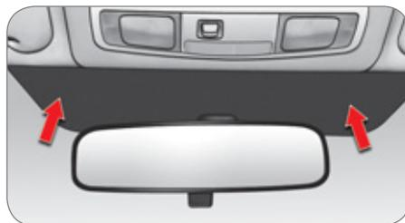
Le pare-brise athermique comporte une zone non réfléchissante située au-dessus de la base du rétroviseur intérieur. Elle est destinée à l'apposition des cartes de télépéage et/ou de parking.
