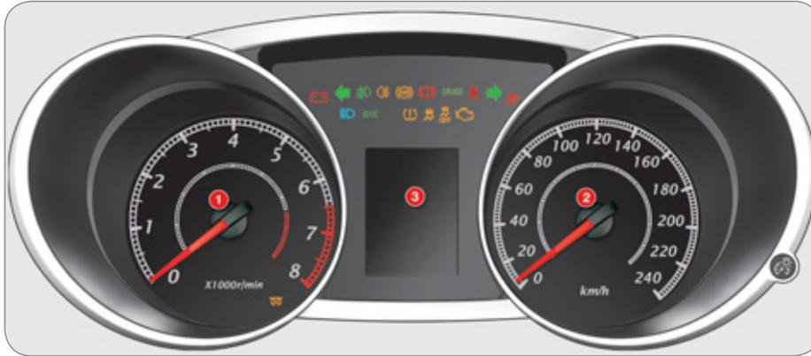
Panneau regroupant les cadrans et les témoins. Ceux-ci informant le conducteur de la mise en marche d'un système (témoins de marche ou de neutralisation) ou de l'apparition d'une anomalie (témoin d'alerte).
