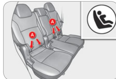
Deux anneaux **A**, situés entre le dossier et l'assise du siège du véhicule permettent de fixer un siège enfants.
