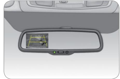
Combiné à une caméra montée à l'arrière du véhicule, ce rétroviseur permet au conducteur de visualiser ce qui se trouve derrière son véhicule lorsqu'il effectue une marche arrière.
