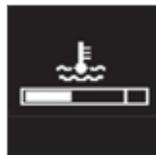
Moteur tournant, il indique la température du liquide de refroidissement.
