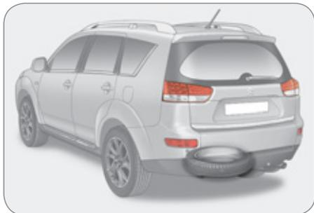
La roue de secours de type «**galette**» est installée à l'extérieur, sous le coffre, maintenue par un panier en métal.
