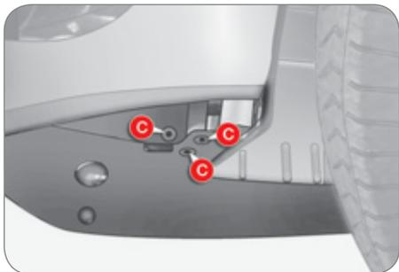
Retirez à l'aide d'un tournevis, les trois clips **C** situés sous le pare-chocs.
