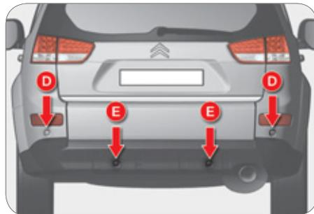
Il détecte tout obstacle (personne, véhicule, arbre, barrière,...) situé derrière le véhicule.
