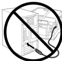
Tilslut ikke USB-kablet, før du bliver bedt om det.
